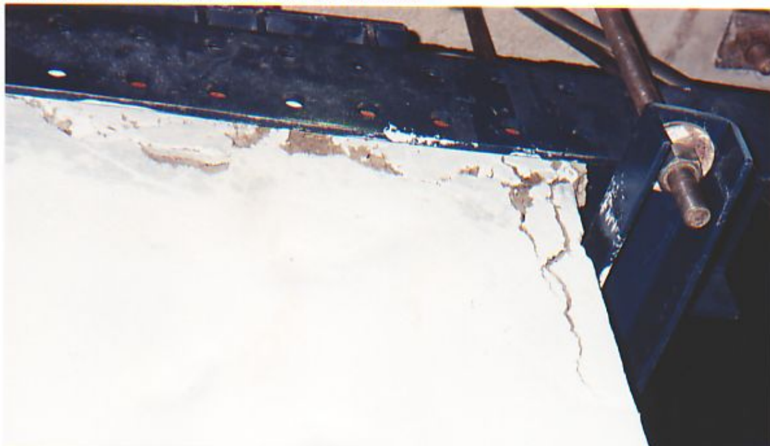
FOTO N° 3: Detalle de la falla por aplastamiento del apoyo superior en Panel P-C-02 después del ensayo de compresión.
