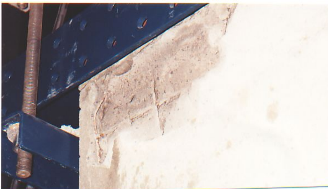
FOTO N° 4: Detalle de la falla por aplastamiento del apoyo superior en Panel P-C-02 después del ensayo de compresión.
